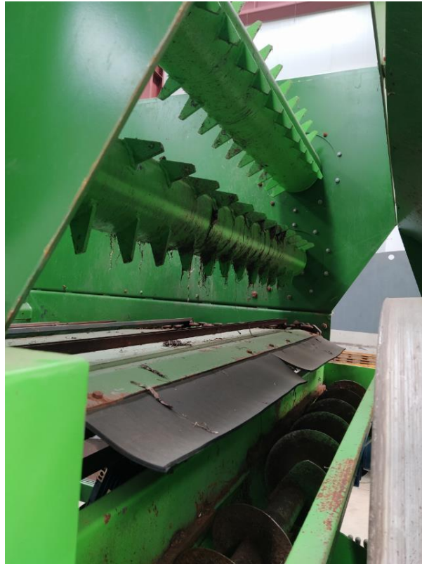
Figura 4. Rodillos desmenuzadores y tornillo sinfín de alimentación.
