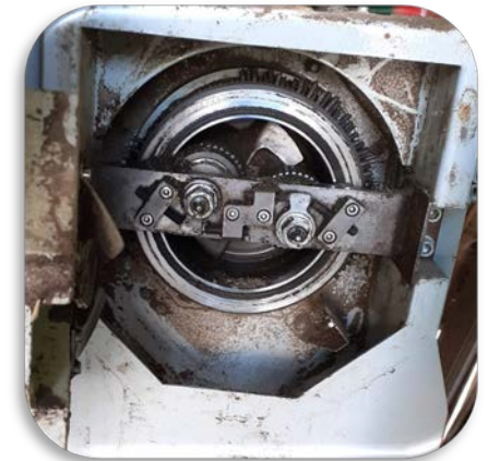
Matriz de peletizado con rodillos de presión
