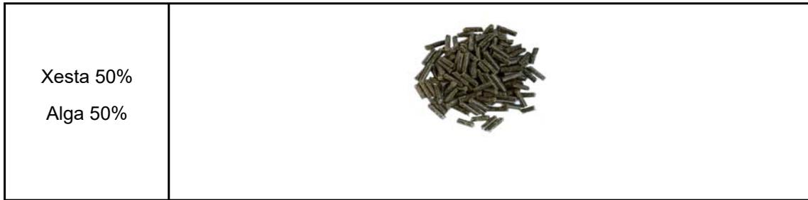
**Figura 6.** Pellets de cosustratos, alga y mezclas obtenidos tras el proceso de densificación.
