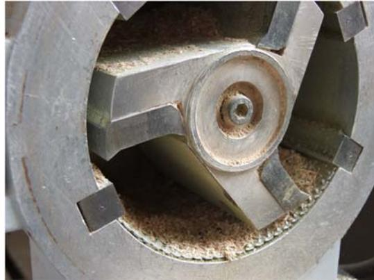
**Figura 3.** Molino de cuchillas con malla 1 mm.
