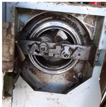
**Figura 5.** Matriz de peletizado con rodillos de presión.
