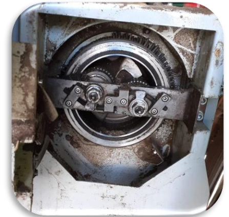
Matriz de peletizado con rodillos de presión
